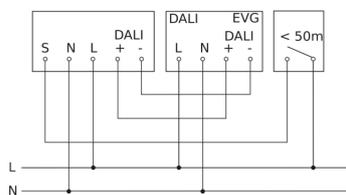
Schema elettrico Master-Slave collegamento in rete
